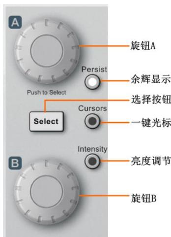
图 5.11 多功能旋钮区面板
