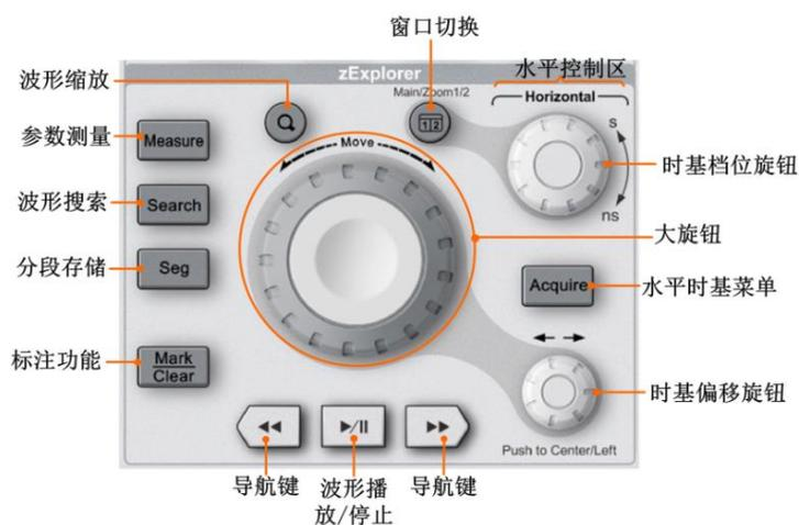
图 5.12 波形探测区
