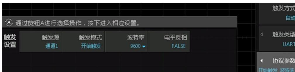
图 10.57 UART 触发协议参数
