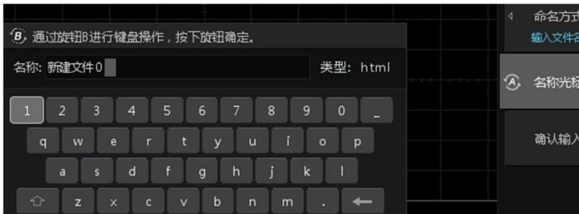
当按下“名称光标”软键，则光标跳转至文件名称输入栏，此时用旋钮A控制光标位置，再按下“名称光标”软键，则光标跳转至键盘，此时用旋钮B控制光标位置
