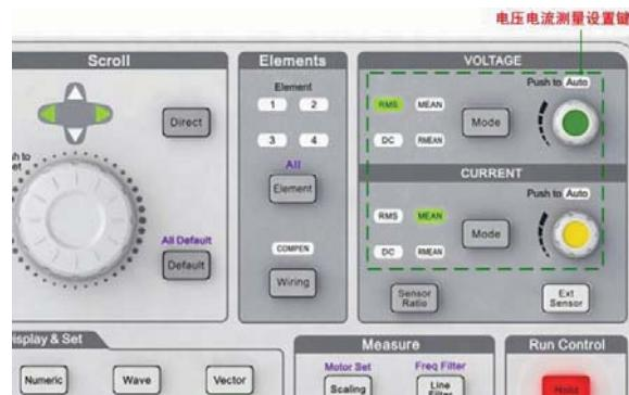
图 3.7 电压/电流测量设置键区
