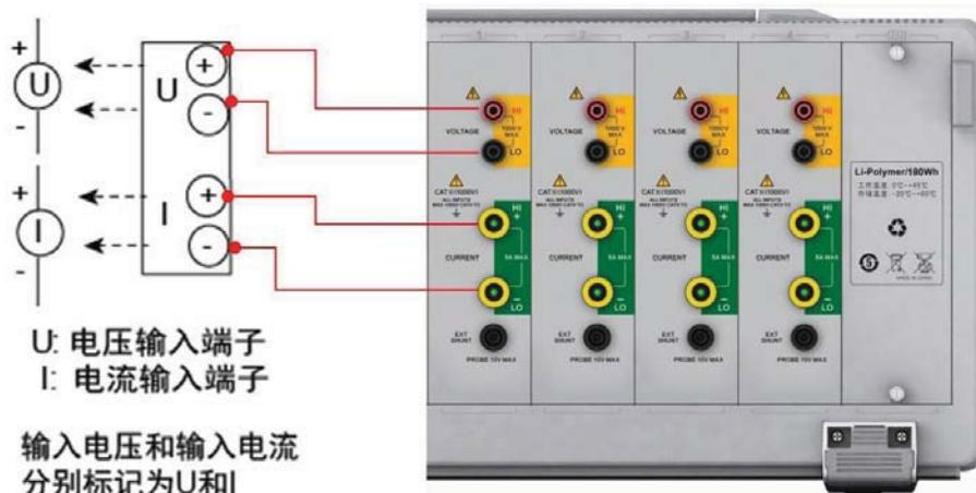
图 4.1 电压端子/电流端子输入符号
