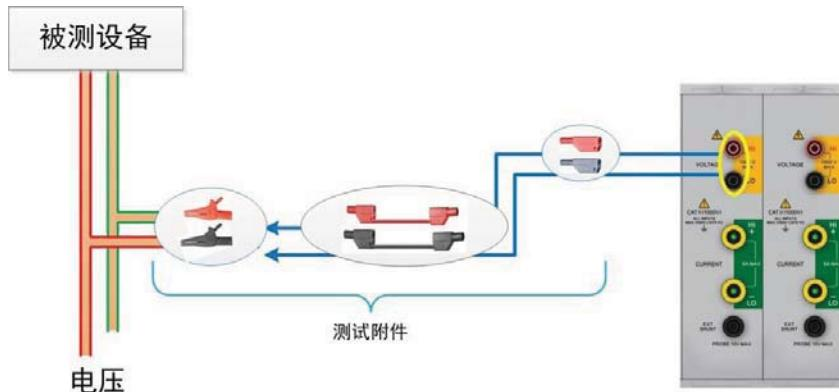
图 4.7 使用电压输入端子直接测量电压
