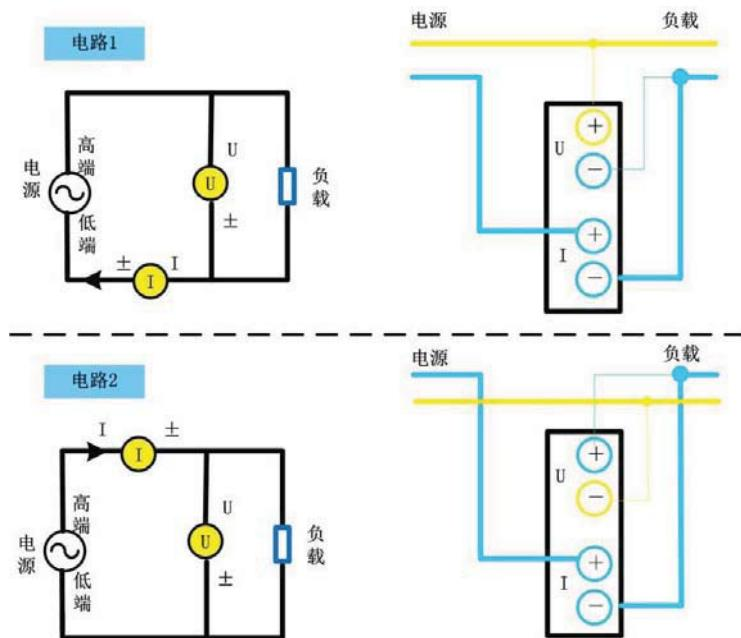
图 4.5 单相 2 线制(1P2W), 测量仪表的接线
