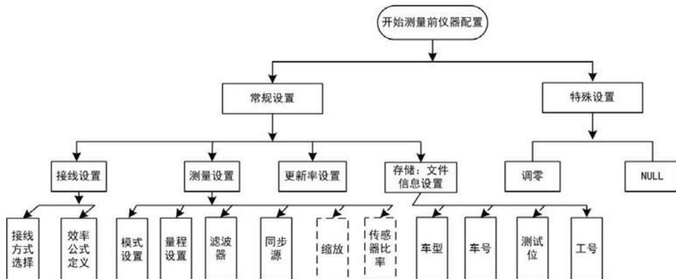
图 5.2 测试前仪器相关设置示意图
