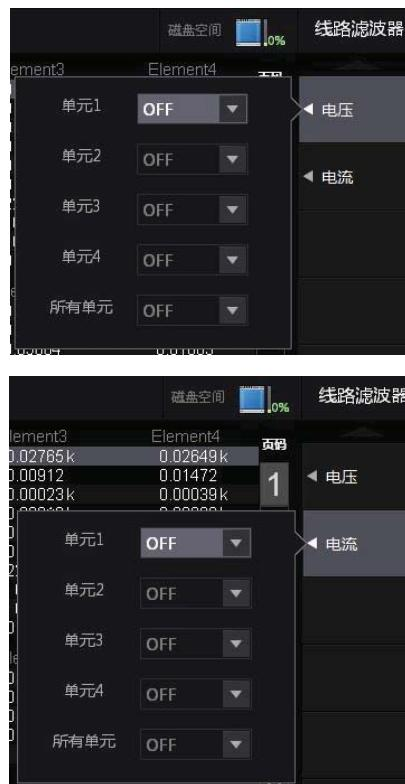
图 5.17 选择须配置线路滤波器的对象单元
