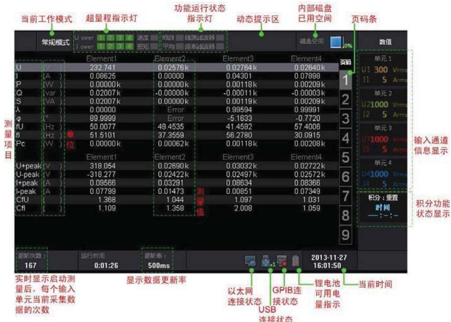
图 3.2 常规测量模式下的屏幕显示实例
