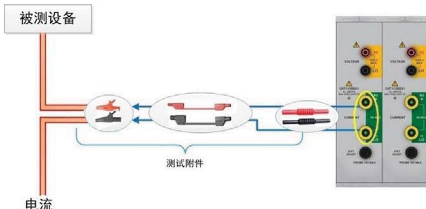
图 4.8 使用电流输入端子直接测量电流
