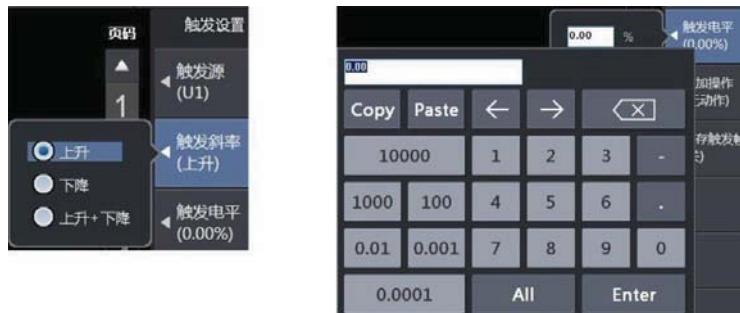
图 6.31 触发斜率和触发电平
