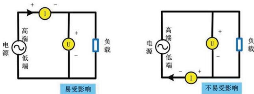
图 4.3 降低杂散电容对测量精度的影响
