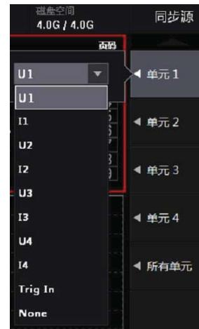
图 5.21 选择须配置同步源的输入单元
