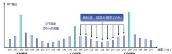
风电行业还有最新的低电压穿越测试标准：在IEC61000-4-7的谐波算法的前提下，还需计算以下三项数据：
