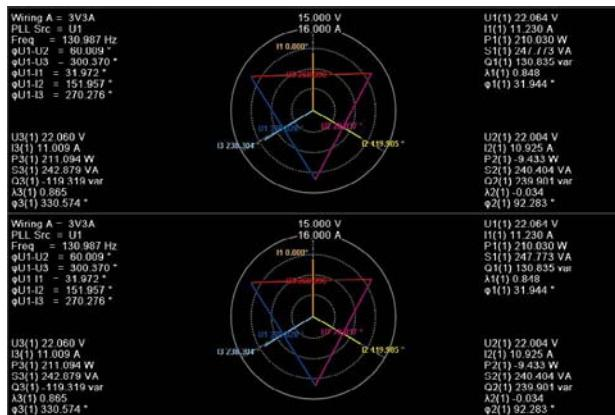
机器人行业对多电机的控制和测试要求很高，需要同时测试多台电机与驱动器，这样就需要一台可以多通道同时测量的功率分析仪，PA8000、PA5000H功率分析仪拥有5MHz带宽，双PLL源和高达500次的谐波测量，另外还独家标配了60G数据存储功能，最重要的是支持多通道电机板卡同步测量，可完美解决机器人行业的用户需求。
