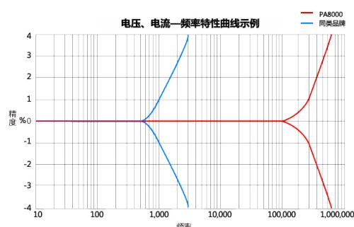
PA8000采用了幅频响应自动补偿技术，能够明显改善整个测量频率范围内的幅频响应曲线，即使在测量高频信号时也能保证高精度测量。不仅如此，PA8000还通过了层层验证，它不但可以提供高精度测量功能，还能保证每次测量结果的一致性。
